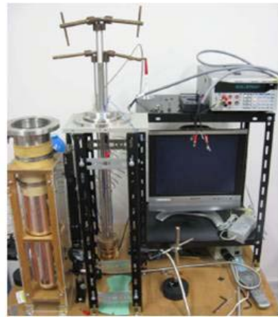
図 1 : 水素ガスの低温液化充填装置
