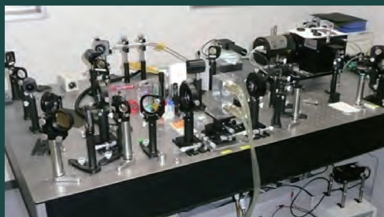
地球中心核の高温・高圧状態を再現するダイヤモンドアンビル装置
