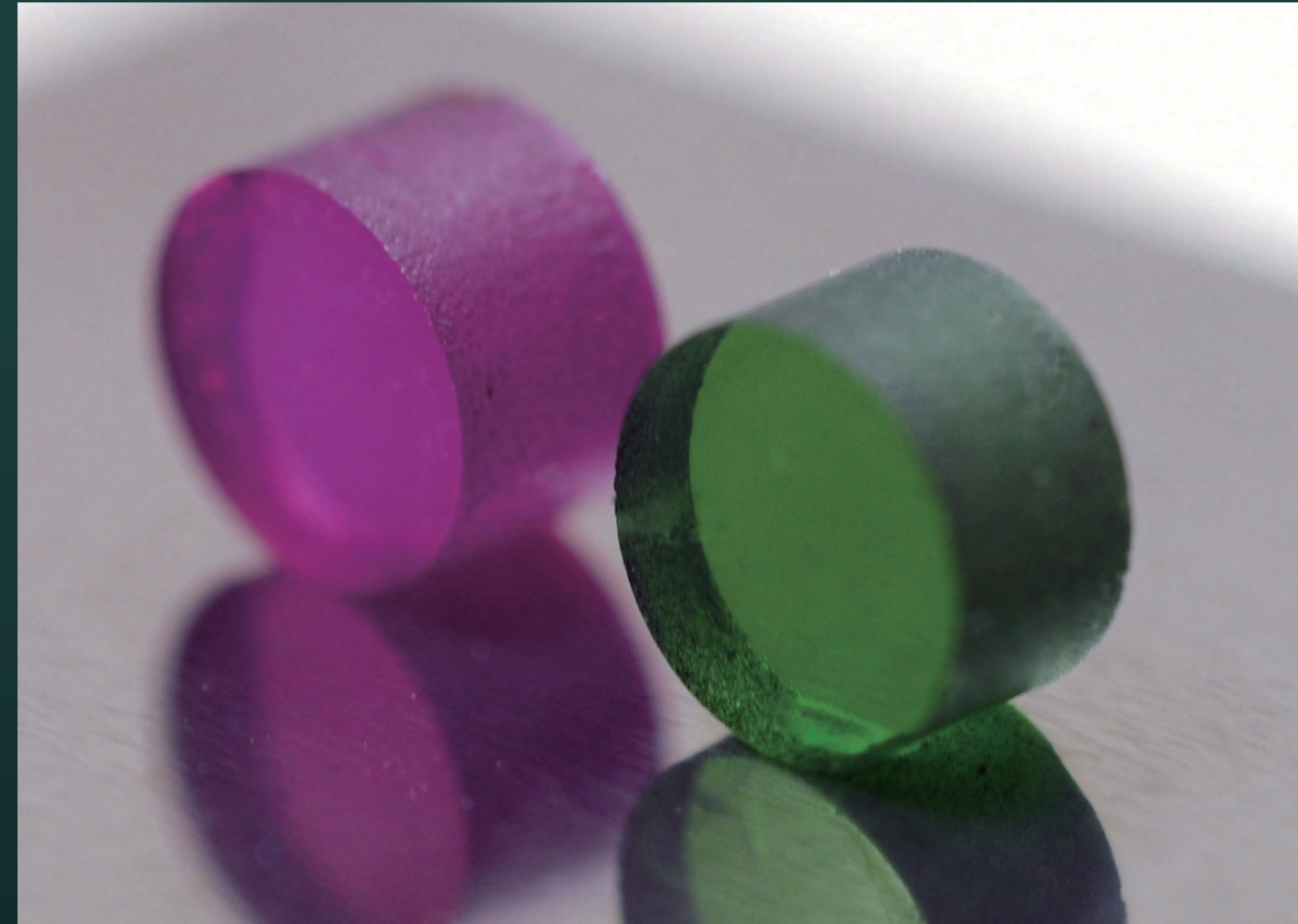
透光性ナノ多結晶ガーネット (左) Pyrope (5 mol% knorringite) (右) Grossular (2 mol% urarovite)
