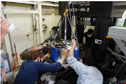
大型放射光施設 SPring-8 のビームライン BL04B1 に設置されている川井型マルチアンビル装置 SPEED-MkII と組み合わせて使用する「高圧変形実験用 D111 型ガイドブロック」を、2021 年 3 月に導入し、D111 型高圧変形装置（以下では D111 型装置）のシステムを整備しました。これまで SPEED-MkII では、2010 年に愛媛大学から導入され
