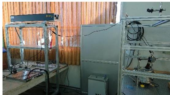
2020年度にGRCに新たな装置として、レーザー加熱浮遊炉装置が導入され、無容器法でのガラス合成手法の開発に取り組んでいます。無容器法とは、試料を空中に浮遊させて加熱熔融し、空中浮遊状態を保持したまま冷却・回収する方法です。容器がないことで核生成は抑制され、一般的な容器を用いた電気炉での試料合成ではガラス化させることが困難な組成についても、無容器法ではガラスを合成することができる場合が多くあります。例えば、1mm以下の小さいサイズに限られますが、Mg<sub>2</sub>SiO<sub>4</sub> かんらん石組成のガラスの合成などが可能なことが報告されています。さらに、200WのCO<sub>2</sub>レーザーを使用した加熱により、一般的な電気炉では到達できない2000°C以上の試料の熔融も可能となっています。そのため、地球科学物質だけでなく、物理学・材料科学などで取り扱う融点
